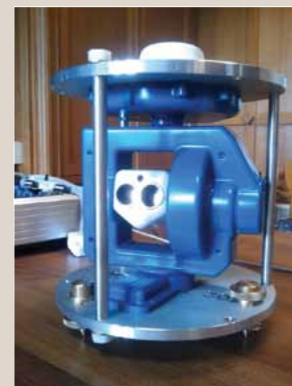
L'Autodif avec le nouveau système de visée mire et les capots de protection.
